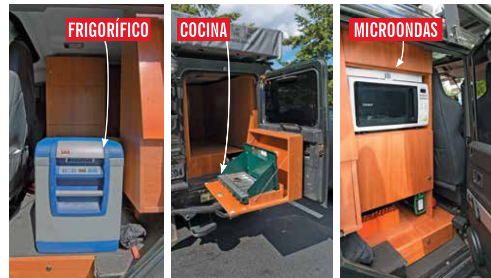
Todo el mobiliario interior se ha realizado a medida en madera. Es muy sólido, pero aumenta notablemente la masa del vehículo. La cocina, abatible, está integrada en el portón.
